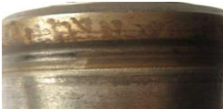
Рисунок 1.4 – Зношування робочої частини валка зі сталі У7
