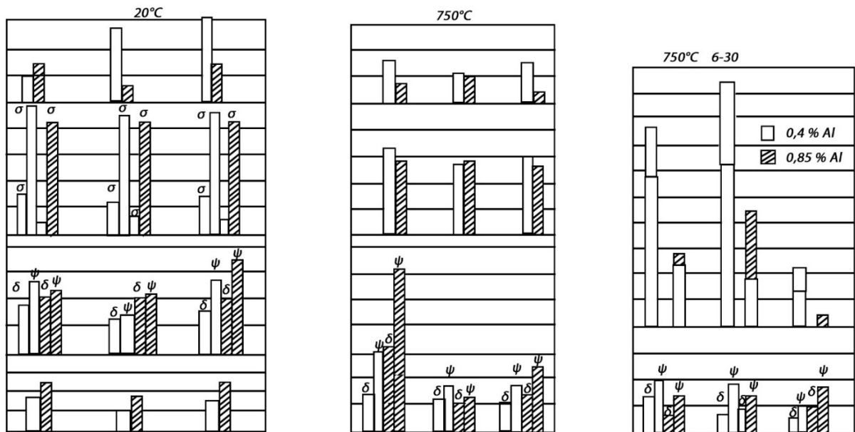
Рисунок 3.8 – Механічні властивості та довготривалу міцність в залежності від швидкості охолодження при гартуванні 1180°C. [11]
