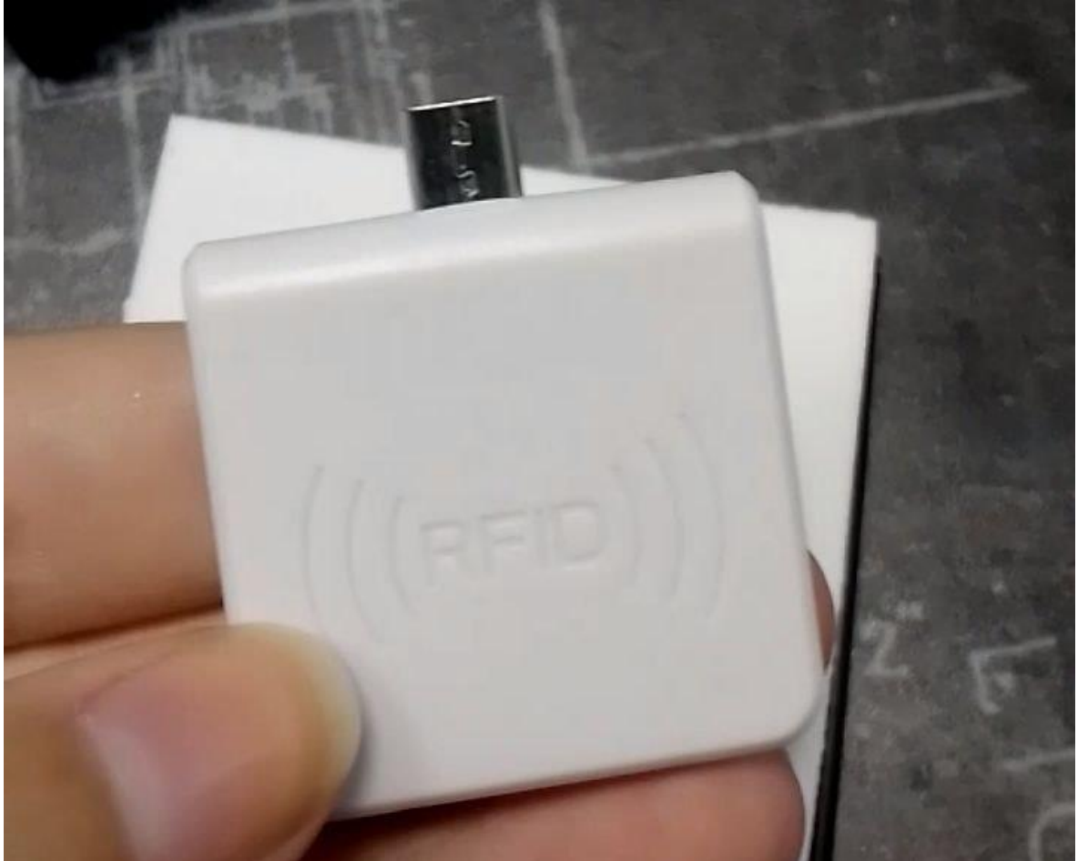
Рисунок 2.2 – RFID-зчитувач для мобільних пристроїв під керівництвом оперативної системи Android
