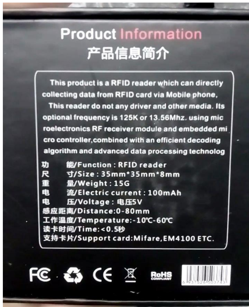
Рисунок 2.3 – Основні параметри зчитувача
