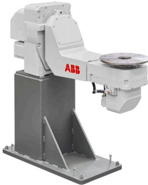
Рисунок 5.15 - Позиціонер ABB IRBP A-250
