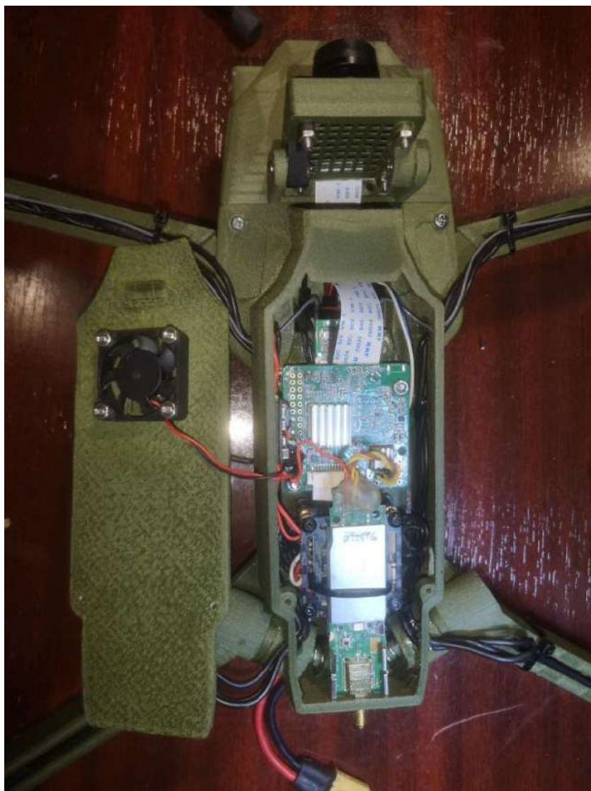
Рисунок 4.9 – Встановлення розробленої системи в БПЛА
