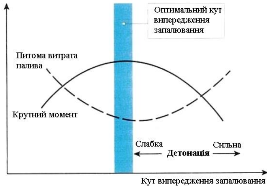
Рисунок 1.1 – Вплив кута випередження запалювання ДВЗ на крутний момент та витрату палива
