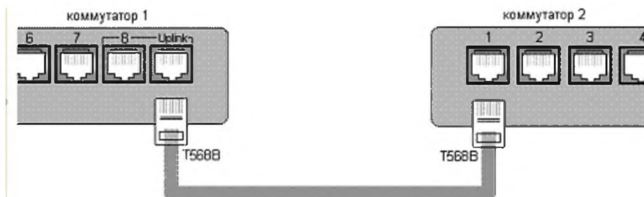
Рисунок 5.5 - Використання порту "Uplink" для підключення кабелю з розводкою по стандарту T568B - T568B
