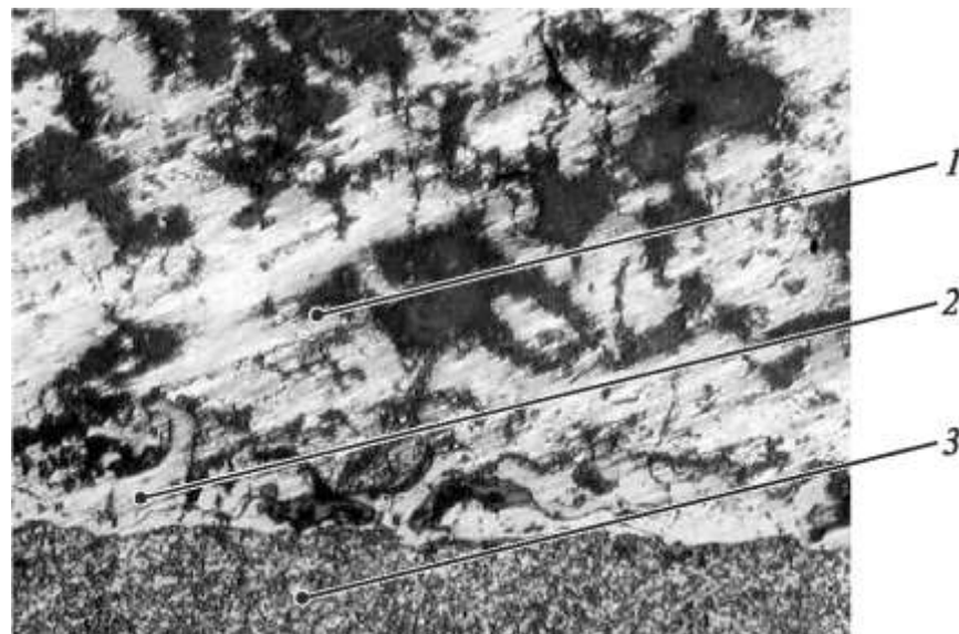
1 - покриття; 2 - підшар; 3 - основа -матеріал ЕП-718-ВД
