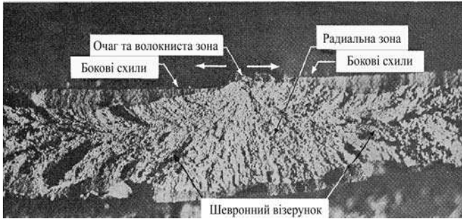
Рисунок 47 – Визначення центру руйнації за видом зламу. Радіальні рубці нижче центру руйнації і шевронний візерунок ліворуч і праворуч визначають напрям розповсюдження тріщини
