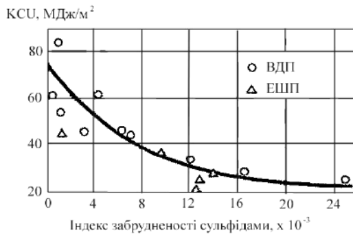
Рисунок 108 – Вплив сульфідних вкраплень на ударну в'язкість високоміцної сталі
