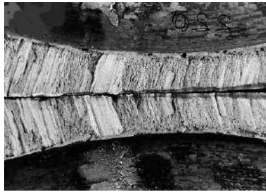
Рисунок 112 – Дефект макрозламу, викликаний плівчастими нітридами алюмінію
