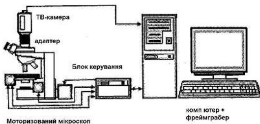
Рисунок 105 – Схема автоматизованого мікроскопу
