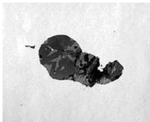
Рисунок 83 – Складний алюмокремнемарганцевий силікат (×500)
