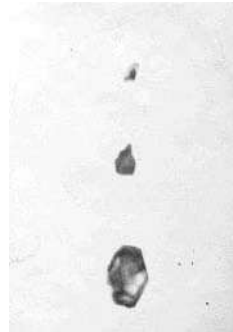
Рисунок 82 – Вкраплення корунду в сталі, що є розкисленою алюмінієм (×500)
