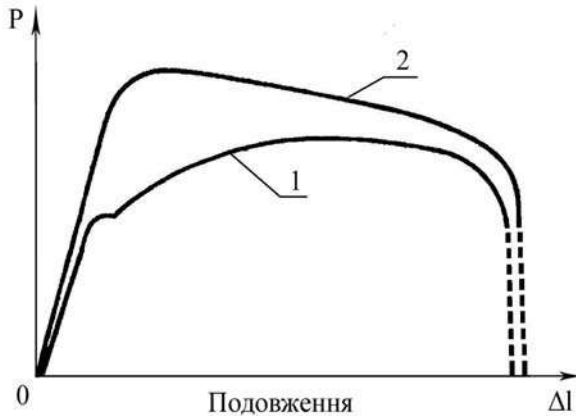
Рисунок 21 – Діаграми розтягнення при статичному (1) та динамічному (2) навантаженні
