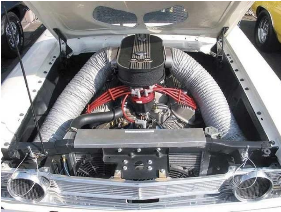
Рисунок 1.3 – Система динамічного наддув, встановлена на двигуні Ford V8 427 автомобіля Ford Fairlane Thunderbolt 1964 року [18]
