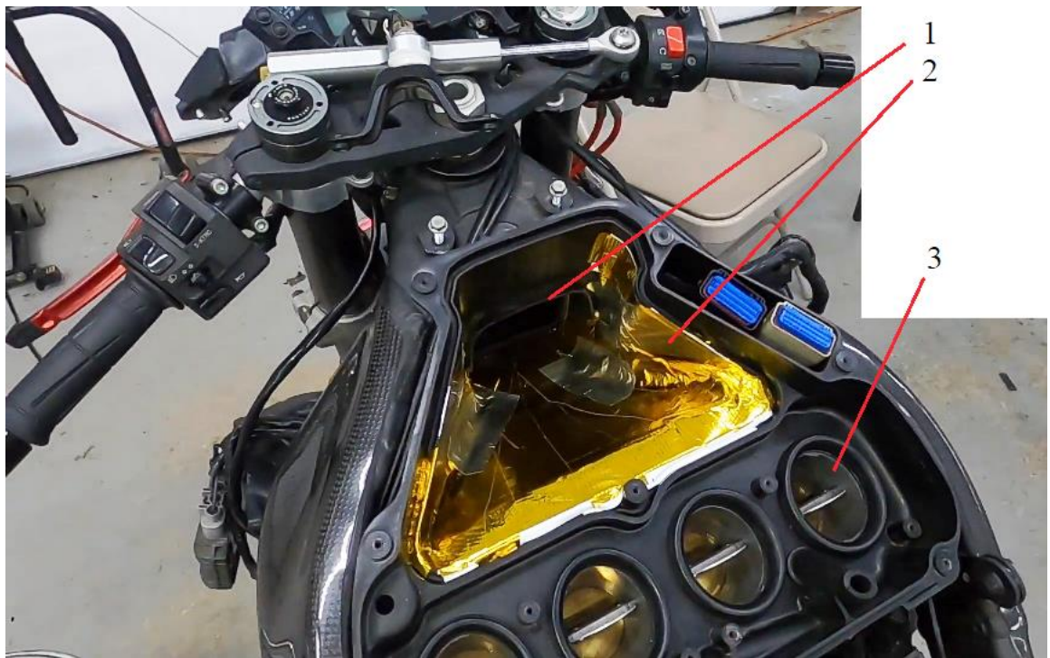
1 – повітрязбірник; 2 – трубопровід; 3 – дросельні заслінки
