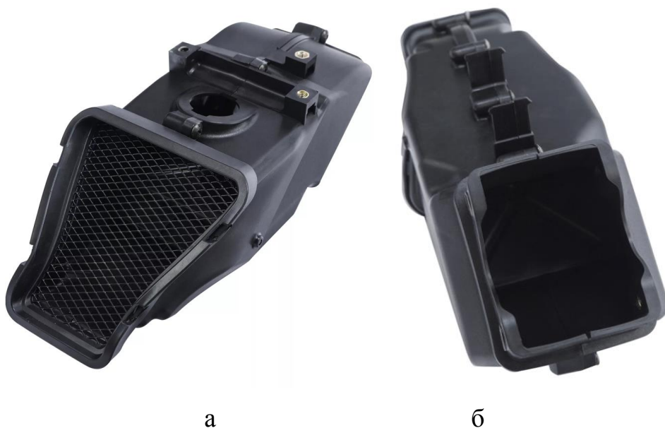
Рисунок 2.3 – Всмоктувальний патрубок системи динамічного наддуву мотоцикла Kawasaki Ninja ZX10R, вид спереду (а), вид ззаду (б) [33]
