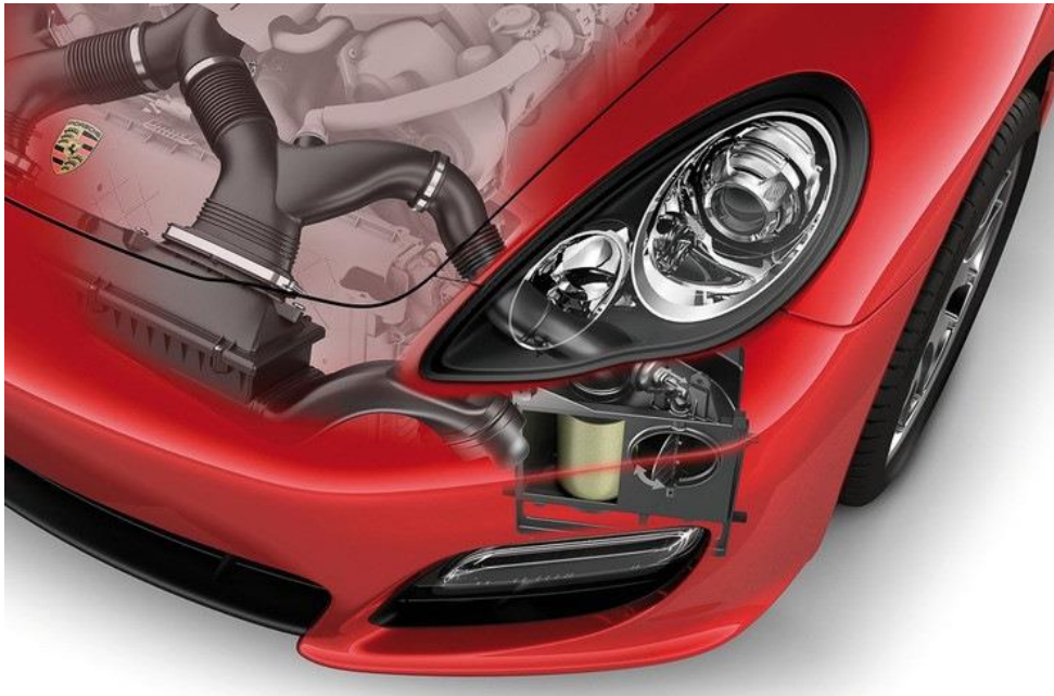
Рисунок 1.5 – Система впуску автомобіля Porsche Panamera GTS
