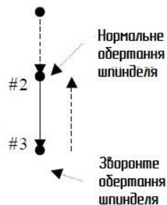
Рисунок 3.5 – G84 – цикл нарізання різьби мітчиком
