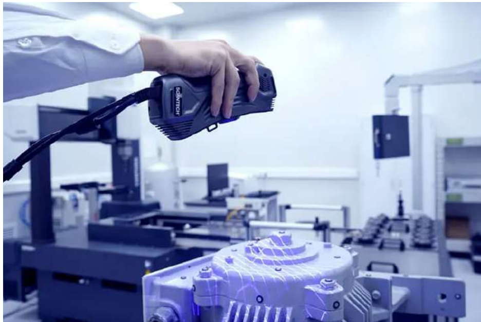
Рисунок 4.1 - Маленький і легкий 3D лазерний сканер – SIMSCAN [7]
