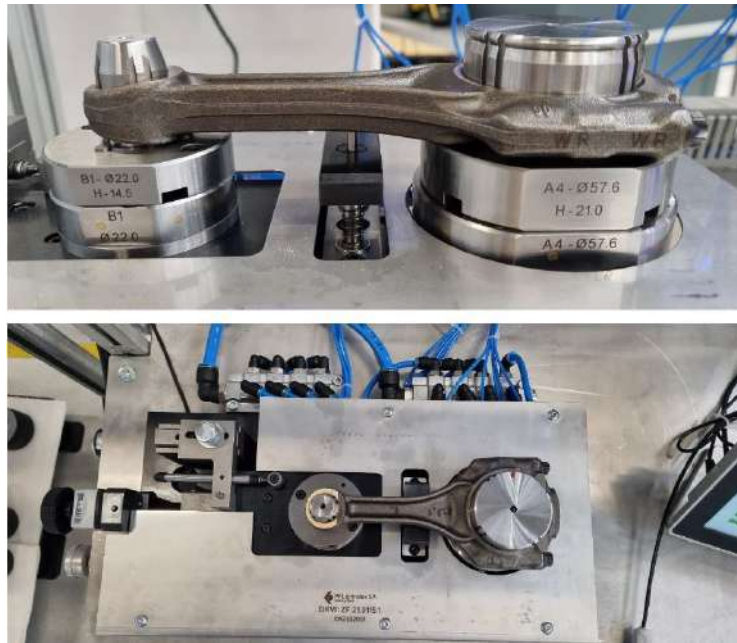
Рисунок 3.7 – Вимірювання геометричних параметрів шатуна [6]
