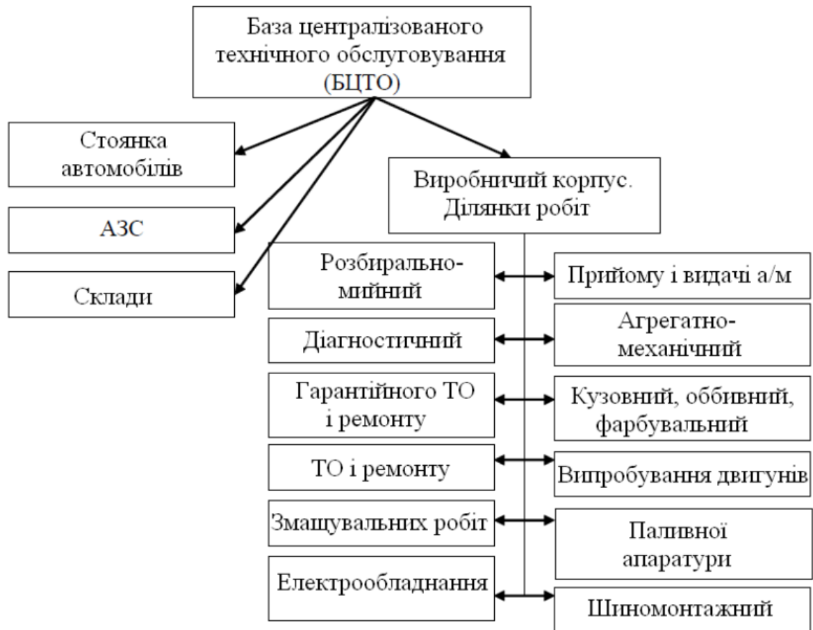
Рисунок 1.4 – Функціональна схема бази централізованого технічного обслуговування
