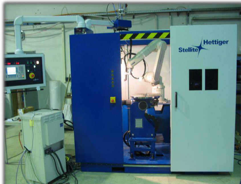
Рисунок 2.2 – Зовнішній вигляд роботизованої установки STARWELD 190H
