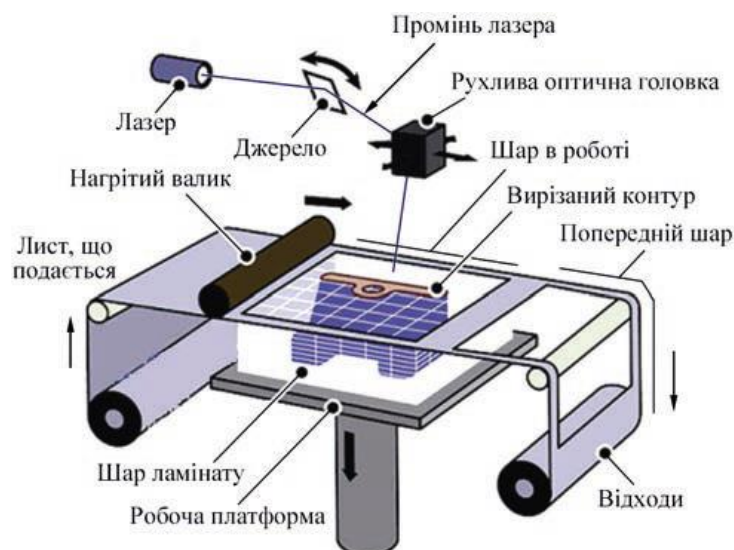
Рисунок 1.8 – Схема процесу LOM 3D-друку [23]
