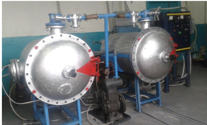
Рисунок 1.8 - Реактор деструкції твердих сплавів методом цинкотермії
