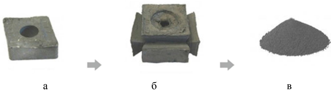
а - вихідна сировина; б - пористий метал; в - подрібнений метал;
