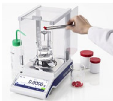
Рисунок 2.5 - Аналітичні ваги для вимірювання густини гідростатичним методом
