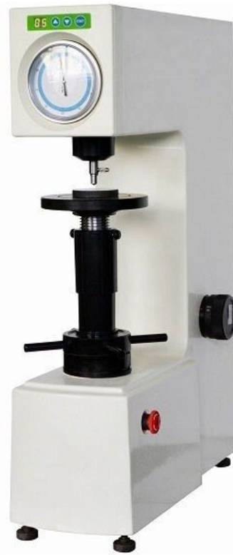
Рисунок 2.3 - Стационарний твердомір Роквелла «Мікротех» типу HRA-1
