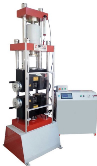
Рисунок 2.2 – Гідравлічна універсальна випробувальна машина «УММ 10Т»
