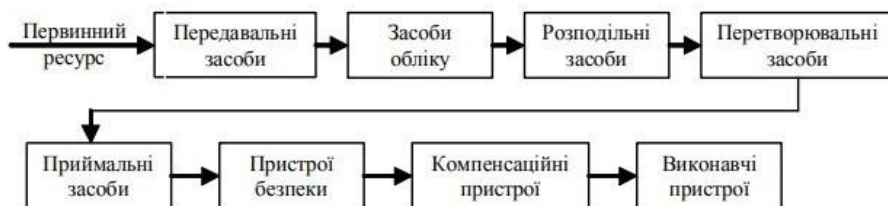
Рисунок 3.2 – Структура технічних засобів енергозабезпечення підприємства
