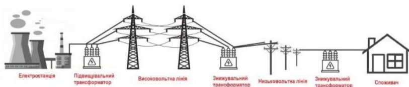
Рисунок 3.1 – Структура технічних засобів енергозабезпечення підприємства
