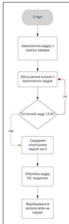
Рисунок 4.1 – Алгоритм розпізнавання за допомогою CoreML моделі
