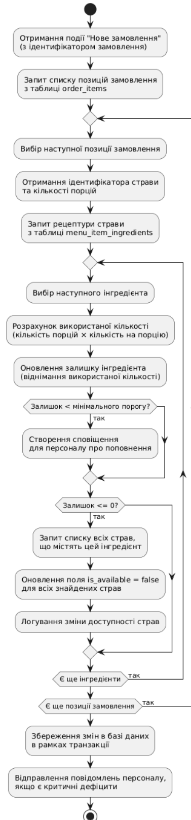
Рисунок 2.11 – Блок-схема алгоритму оновлення залишків
