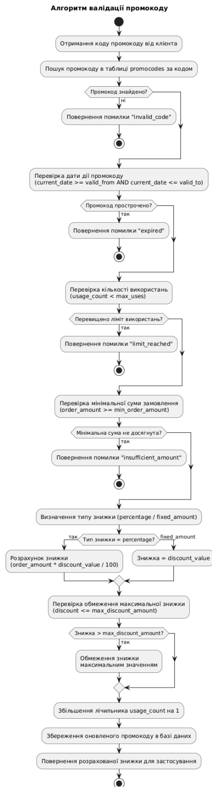
Рисунок 2.12 – Блок-схема алгоритму валідації промокоду
