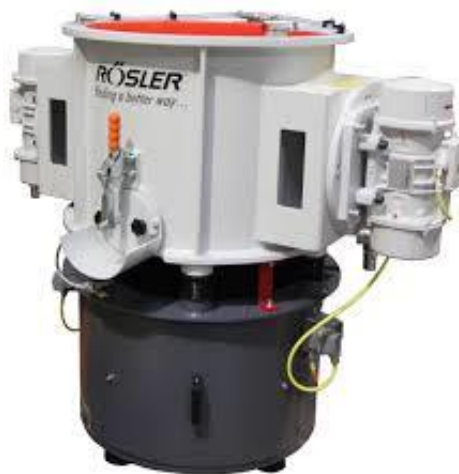
Рисунок 5.3 – Роторна віброгалтовочна машина «DL» для фінішної обробки з двома вібраційними моторами, розташованими за межами технологічного барабану [10].
