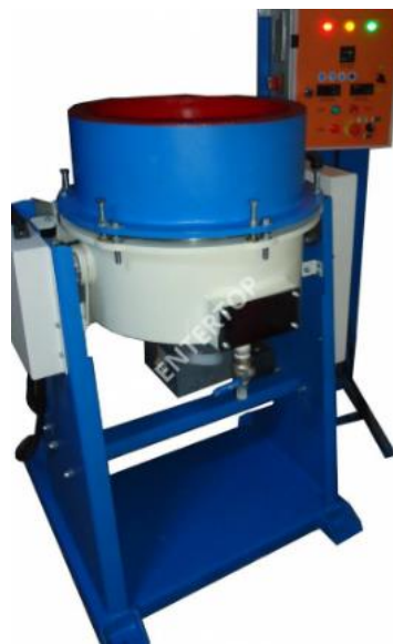
Рисунок 4.3 – Зображення роторної машини без центрального купола [13].
