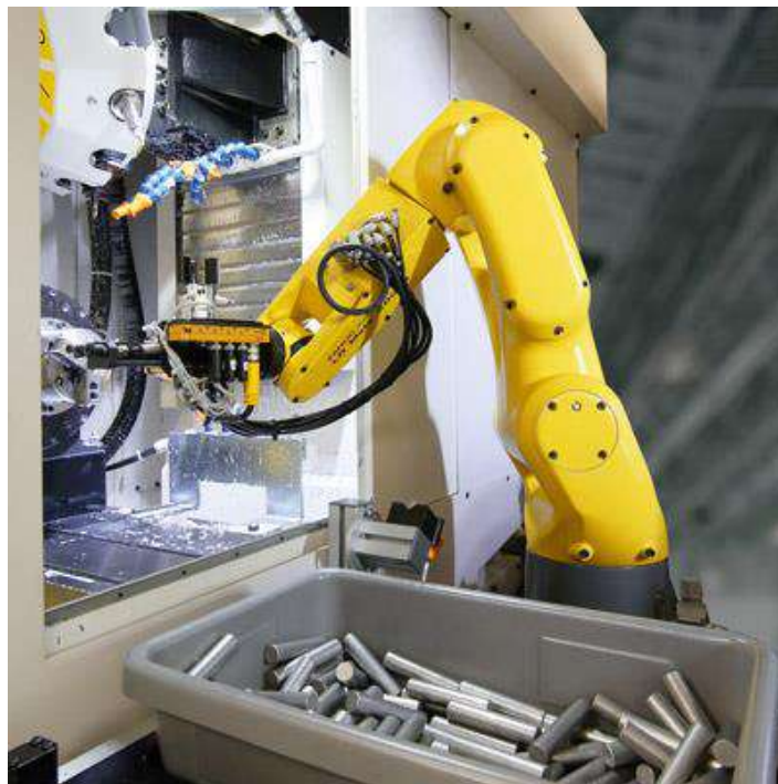
Рисунок 4.2 – Завантаження деталей роботом [17]
