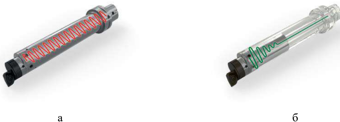
Рисунок 1.1 – Звичайна оправка (а) та з антивібраційною системою (б) [1]
