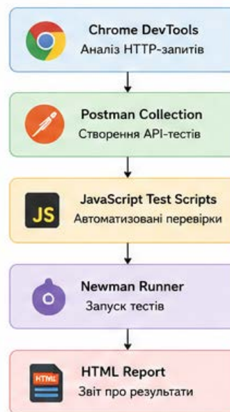
Рисунок 3.1 – Структура програмної системи автоматизованого тестування
