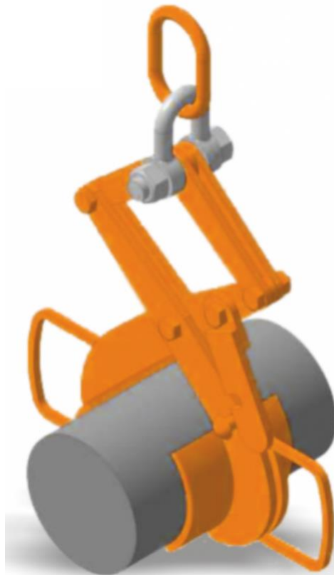
Рисунок 1.5 – Спеціальна траверса зі захватами для транспортування труб
