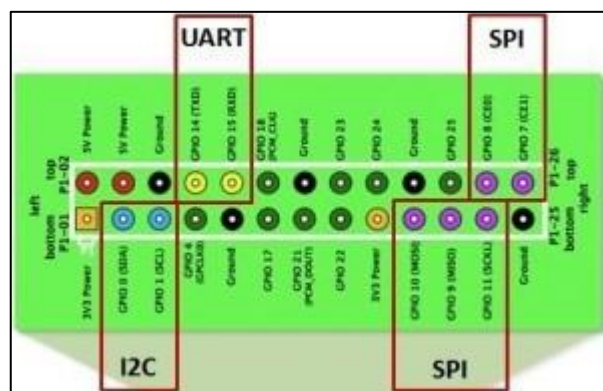
Рисунок 1.5 - Групи контактів для підключення різних інтерфейсів
