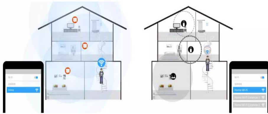
Рисунок 2.5 – Зони покриття Mesh мережі та звичайної Wi-Fi мережі [36]
