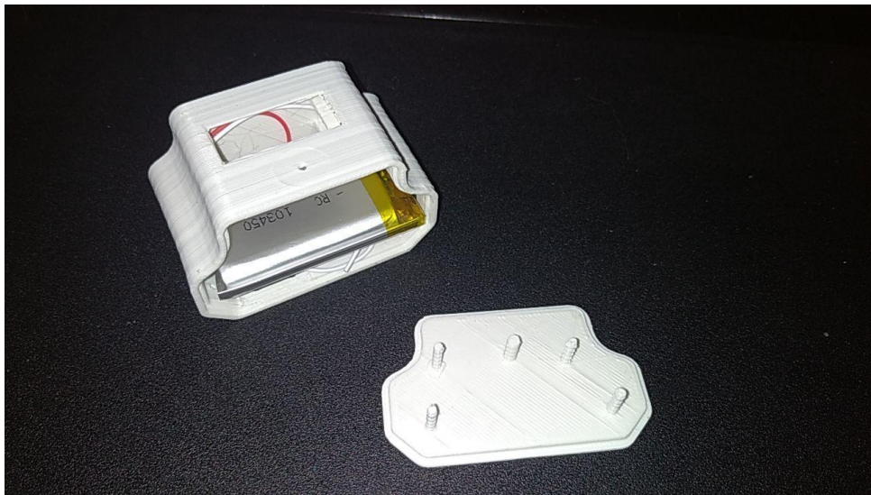
Рисунок 3.37 – Роздруковані частини фізичного прототипу проєктованого браслету
