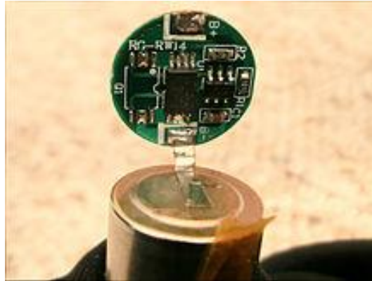
Рисунок 2.3 – Контролер заряду (плата захисту)
