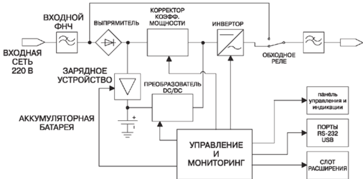
Рисунок 1.3 – Схема побудови ДПЖ з подвійним перетворенням
