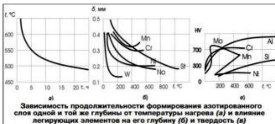
Рисунок 4.7 - Вплив температури і легуючих елементів на формування азотованого шару
