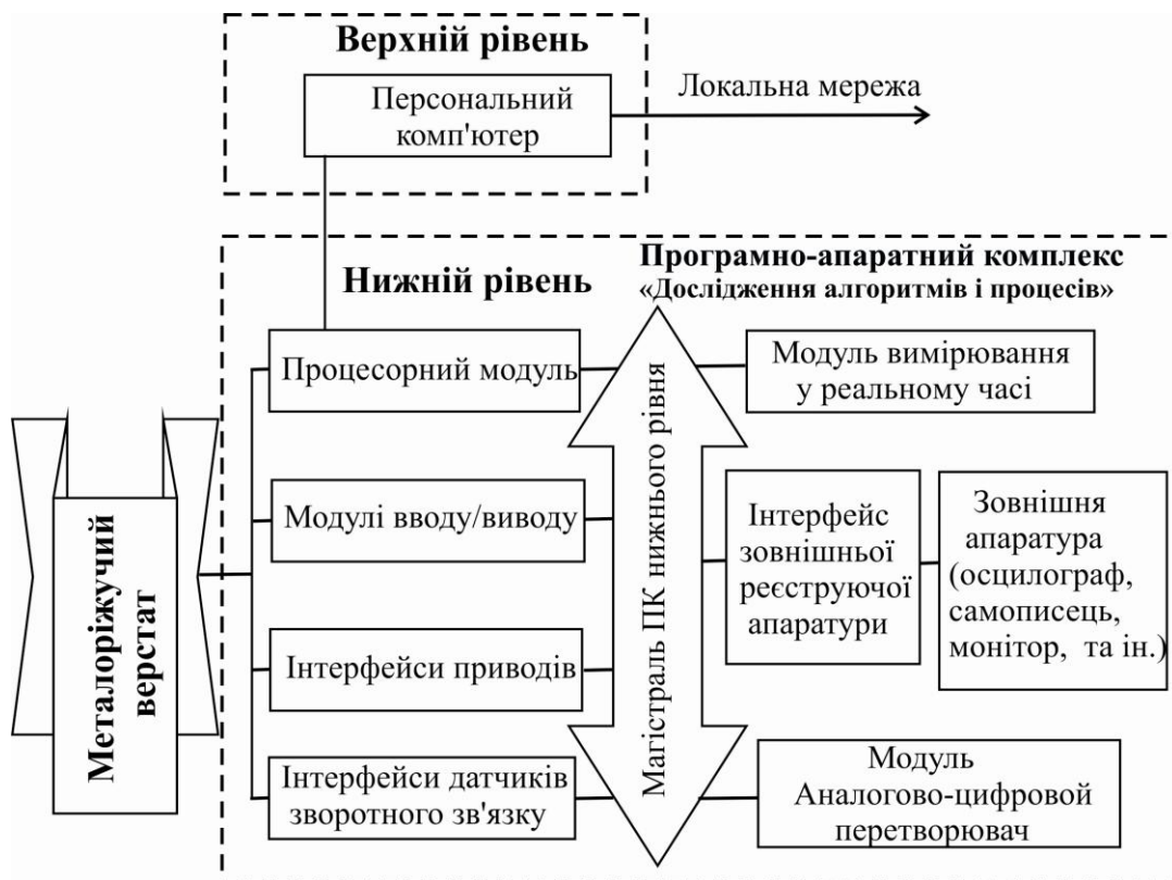
Рисунок 3.1 - Структура апаратного забезпечення СЧПК і ПАК для дослідження алгоритмів і процесів
