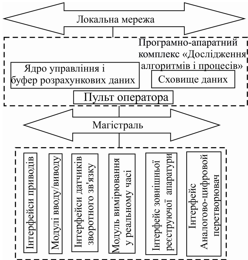
Рисунок 3.2 - Схема структури програмного забезпечення СЧПК і ПАК для дослідження алгоритмів і процесів
