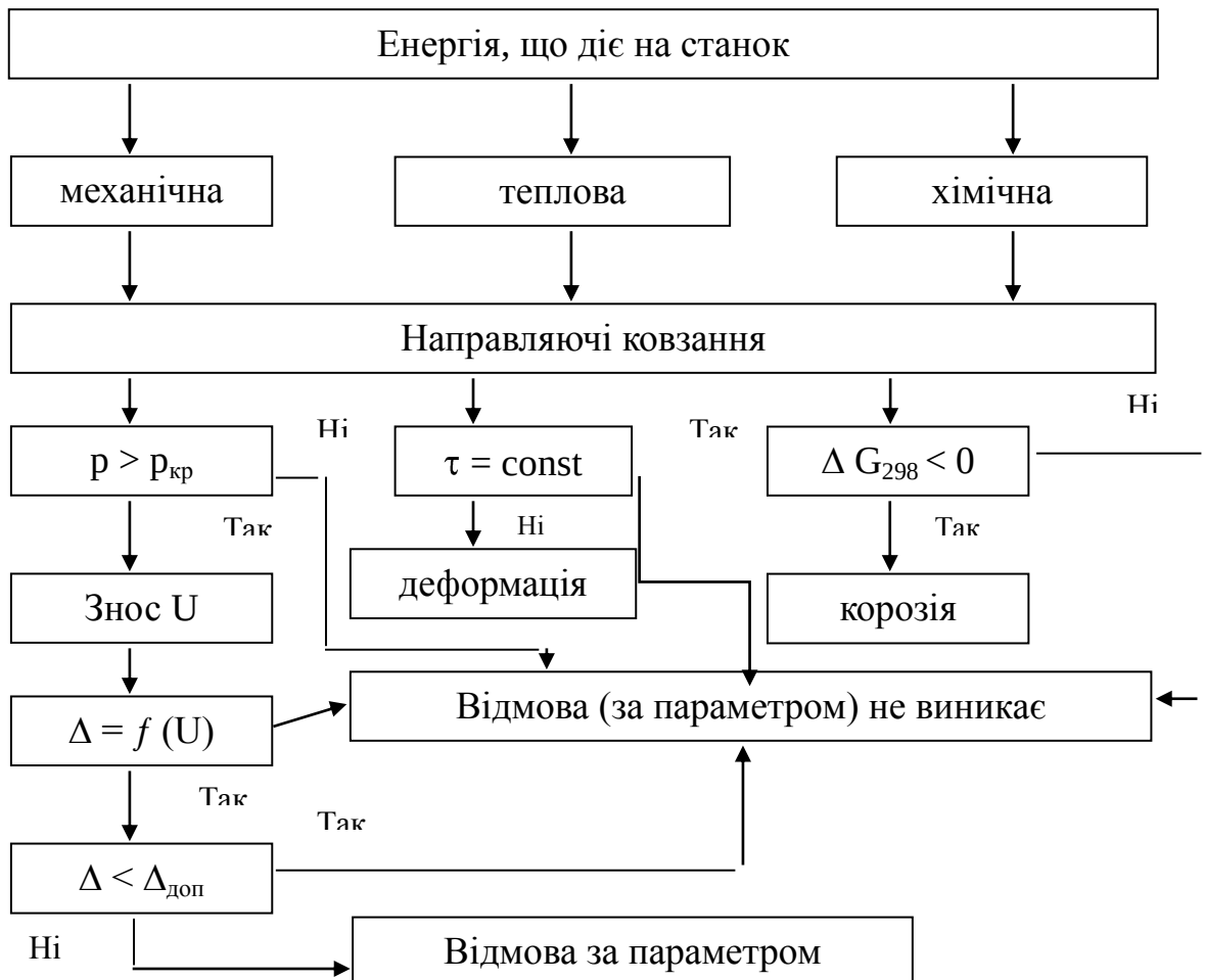
Рисунок 1.4 - Блок-схема відмови спрямівниць верстата
