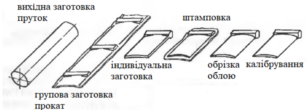
Рисунок 1.12 – Послідовність технологічних переходів штамповки робочих лопаток компресора з прутка
