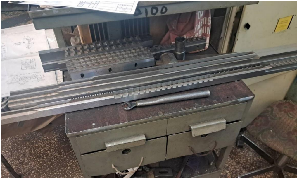
Рисунок 3.6 – Протяжки якими виконується обробка хвостовика лопатки «ластівчин хвіст»
