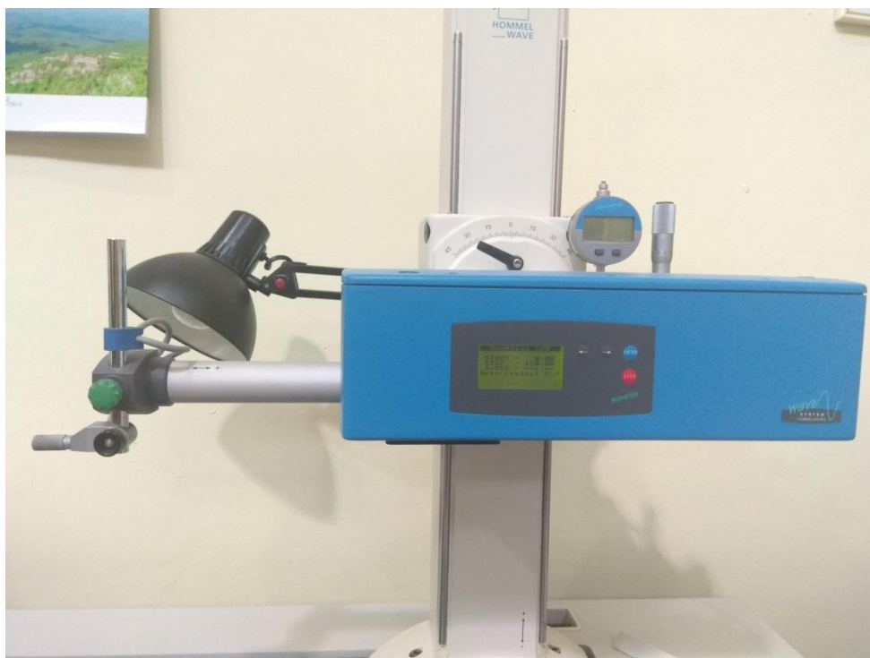
Рисунок 2.3 – Прилад «Hommelwave T8000» для вимірювання параметрів шорсткості
