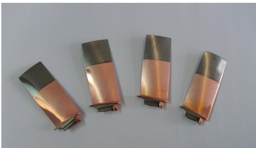
Рисунок 2.2 - Лопатки з покриттям наноструктурованою міддю
