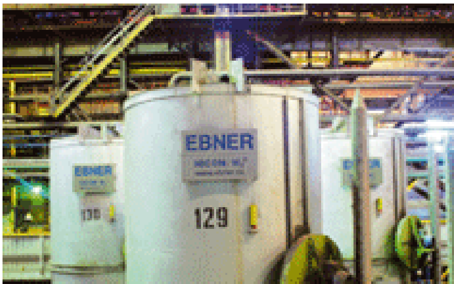
Рисунок 1.3 - Стенди прискореного охолодження металопродукату
