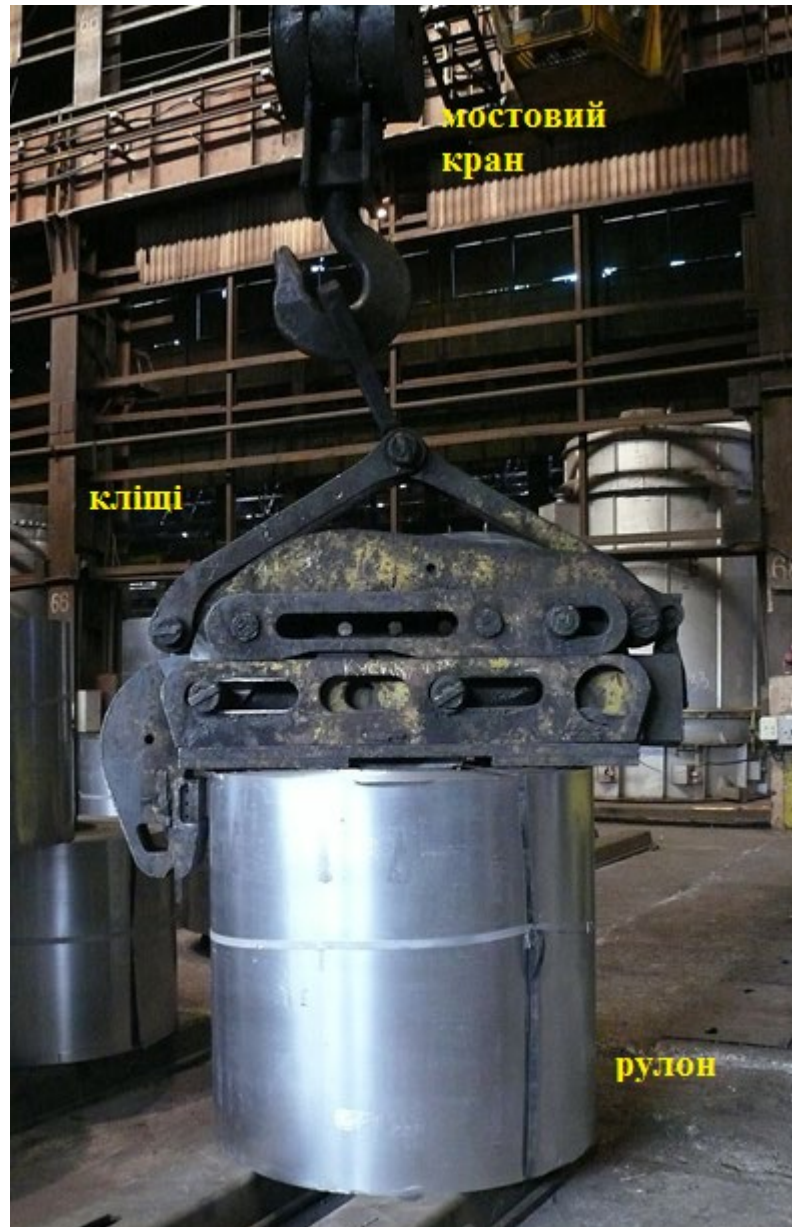
Рисунок 1.8 – Вантажозахоплювальний орган мостового крану - кліщі
