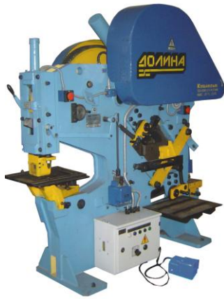
Рис. 4.17 Різання прутка на сортових ножицях: а – зовнішній вигляд механічних сортових ножиць; б – схема різання прутка: 1 – пруток; 2 – верхній ніж; 3 – притискач; 4 – нижній ніж; 5 – упор
