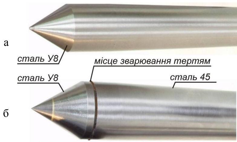
Рис. 5.10 Обертіві центри: а – за звичайною технологією; б – із застосуванням зварювання тертям
