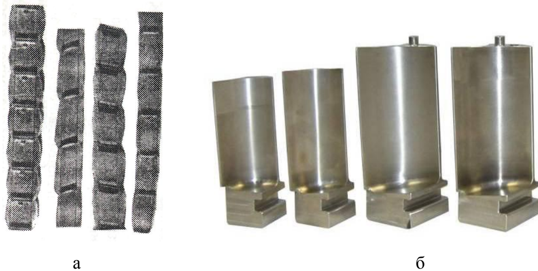
Рис. 11.9 Заготовки компресорних лопаток, отримані періодичними прокатуванням (а) і робочі лопатки компресора (б)
