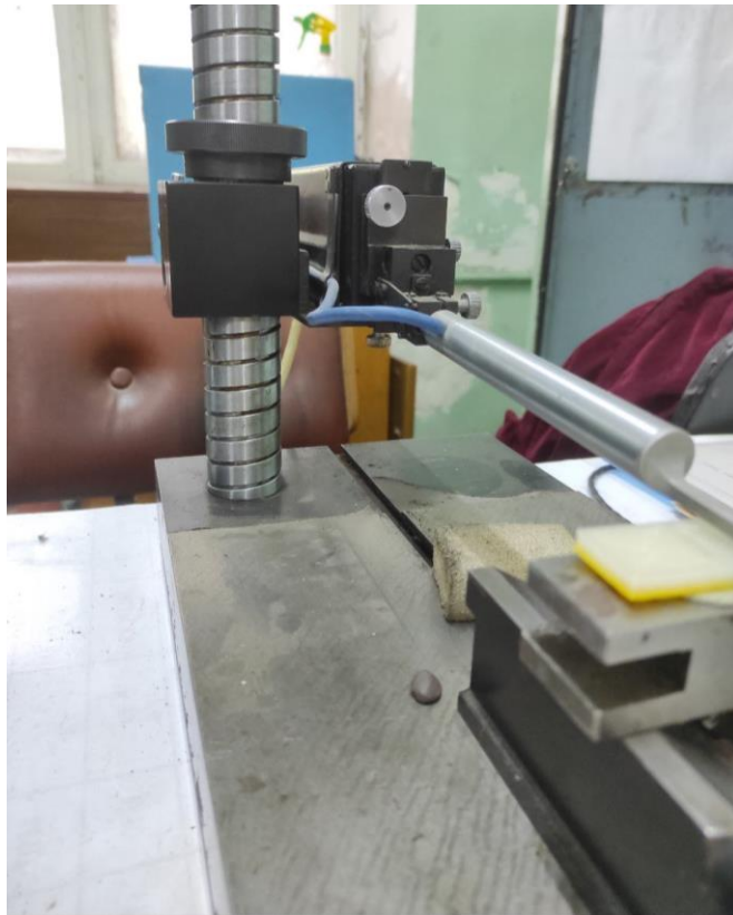
Рисунок 2.7 - Процес визначення шорсткості поверхні
