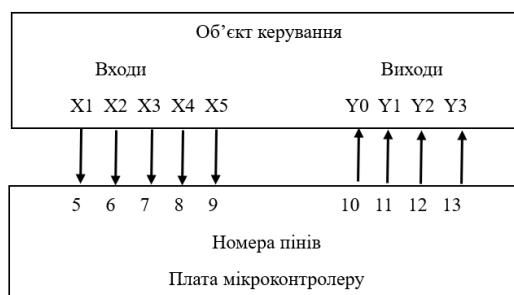
Рисунок 2.3 – Схема під'єднання об'єкту керування до плати мікроконтролера
