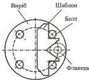
Рисунок 5.7 – Шаблон для встановлення фланця [2]
