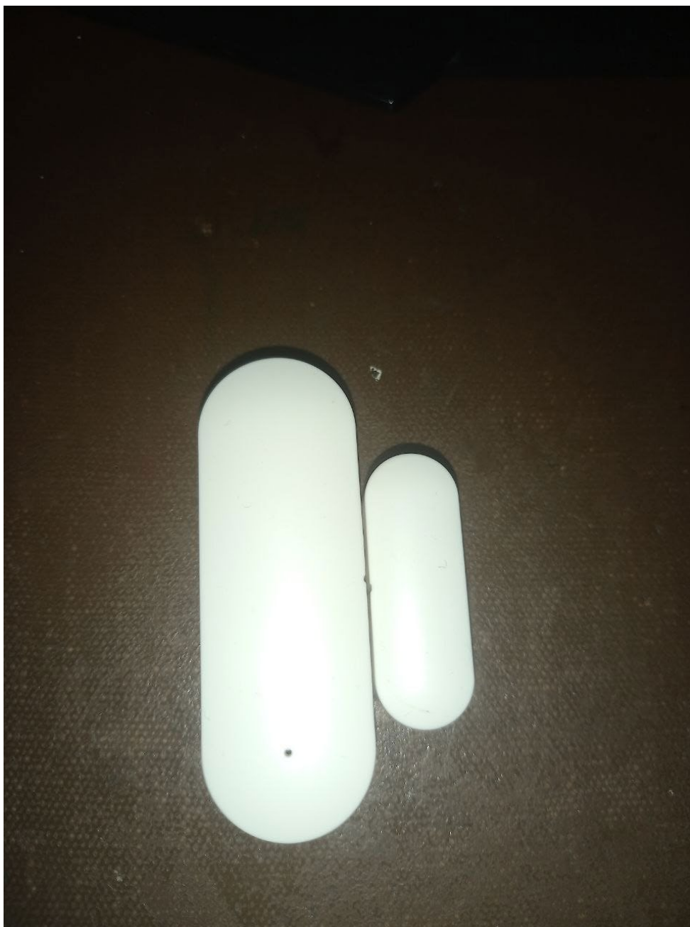
Рисунок 4.9 – Датчик закритої двері
