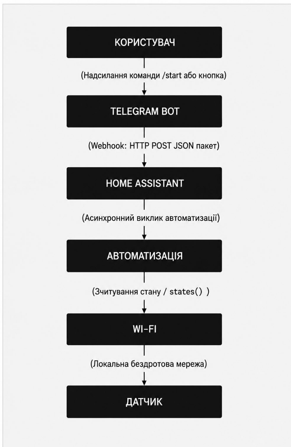
Рисунок 3.3 — Схема інформаційних потоків та автоматизації системи
