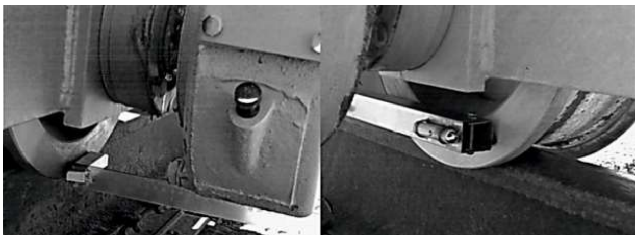
Рисунок 2.4 – Кріплення рамки з лазером і лінійки на ходових колесах крана
