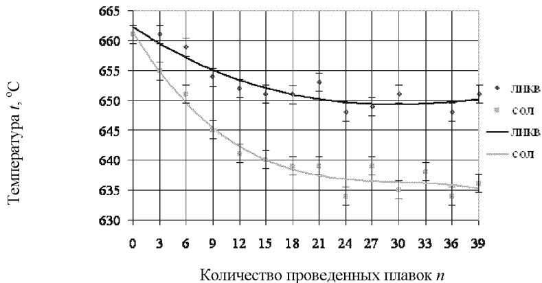
Рисунок 4.23 – Изменение температур ликвидус и солидус алюминия жидкометаллического кристаллизатора в процессе его эксплуатации
