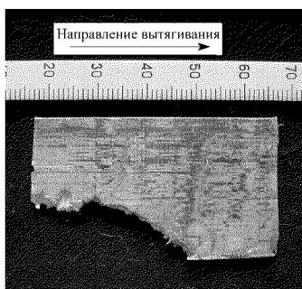
Рисунок 2.27 – Ленточная бронзовая заготовка, полученная при непрерывном режиме вытягивания
