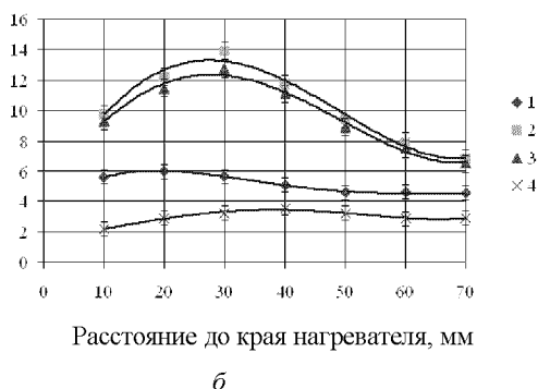
Рисунок 5.7 – Изменение продольного теплового потока Q_1 , в зависимости от расстояния до края нагревателя:
