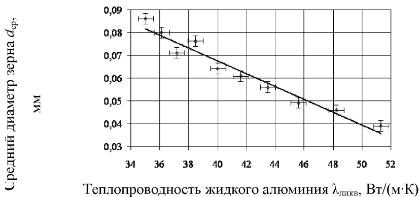
Рисунок 4.22 – Влияние теплопроводности жидкого алюминия при температуре ликвидуса на размер макрозерна
