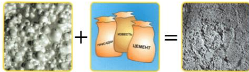
Рисунок 3.4 – «пінопластові шарики» + добавки, присадки=полістиролбетон
