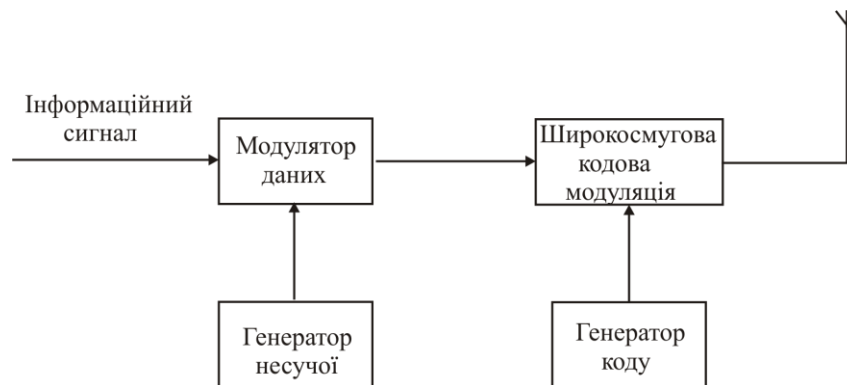
Рисунок 1.7 – Варіант побудови структурної схеми передавача системи зв'язку з використанням DS-CDMA
