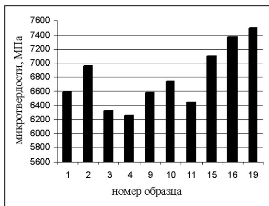
Рис. 6. Микротвердость кристаллов \beta -Si твердого раствора (a) и эвтектики \alpha -Al- \beta -Si (b) в образцах заэвтектического силумина после водородной обработки
