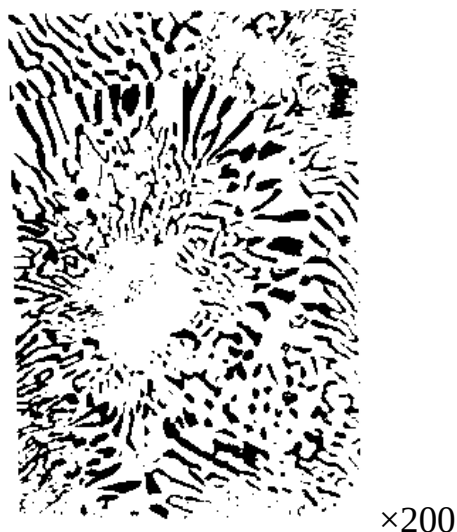
Рисунок 1.1 - Колонія нормальної евтектики в системі Pb - Sn
