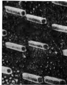
Рисунок 1.8 - Евтектичні стрижні карбіду танталу в матриці на основі кобальта (матриця витравлена так, що видно виступаючі стрижні)
