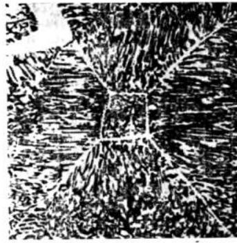
Рисунок 1.4 - Переріз евтектичних секторів колоній Bi + твердий розчин на основі Sn (Bi - світлий, \alpha -Sn темний)
