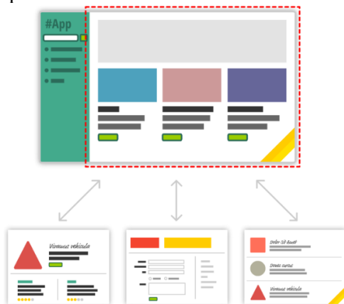
Рисунок 4.1 – Модель односторінкового ReactJS -застосунка
