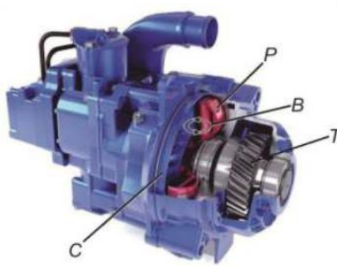
С – статор; Р – ротор; В – циркуляція рідини; Т – трансмісія Рисунок 4.19 – Гідралічне гальмо-сповільнювач
