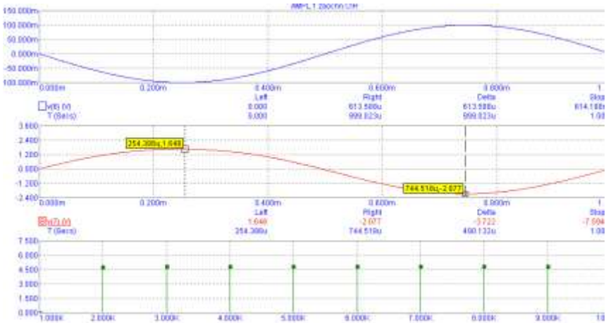
Рисунок 3.12 – Результати моделювання каскаду з V33 для сигнальної складової при амплітуді вхідного сигналу 100 мВ
