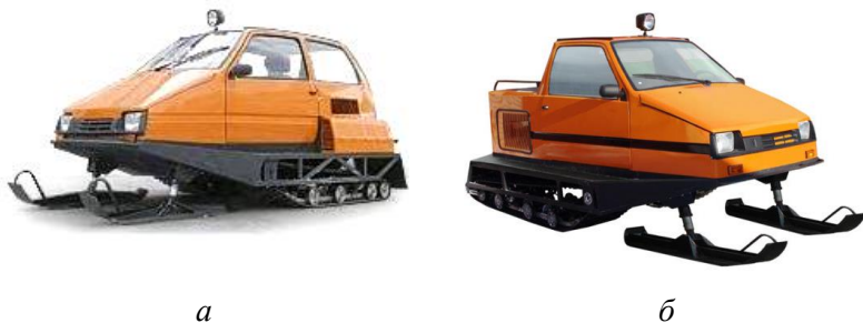
Рисунок 7.2 – Лижно-гусеничний снігохід: а – ТТМ-1901; б – ТТМ-1901-01
