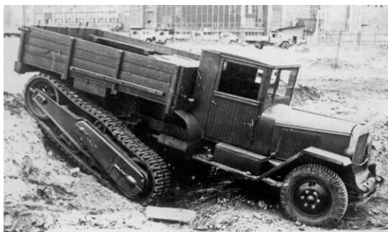
Рисунок 4.4 – Автомобіль ЗИС-42 з комбінованим рушієм
