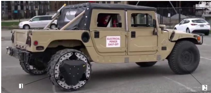
Рисунок 14.1 – Загальний вигляд автомобіля Humvee: 1 – колесо-трансформер (RWT); 2 – звичайне колесо
