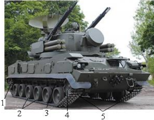
Рисунок 11.2 – Гусеничне шасі ГМ-352 з комплексом озброєння «Тунгуска»:
