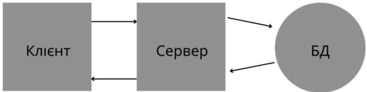
Рисунок 2.4– Схема архітектури клієнт-сервер
