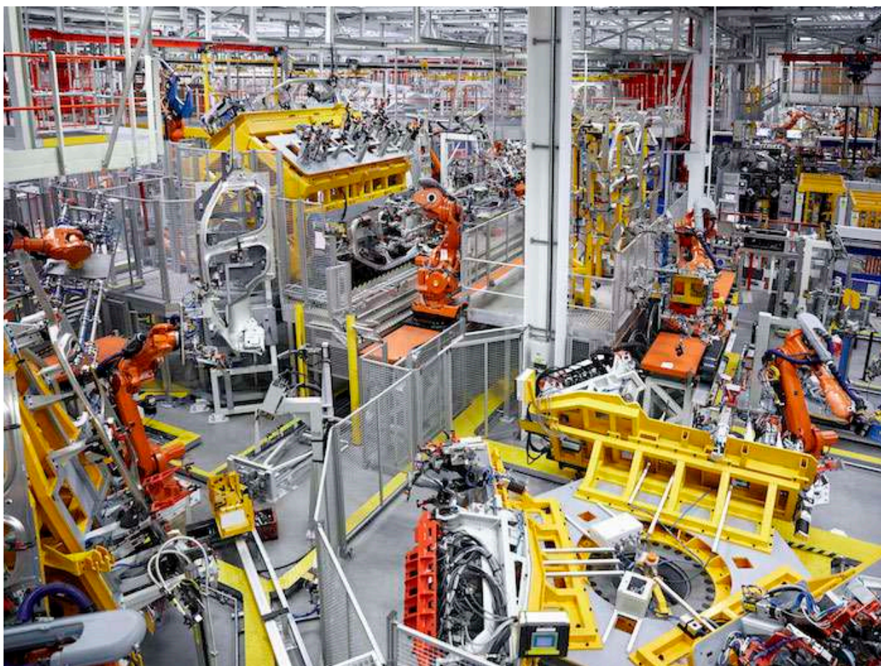
Рисунок 3.2 – Роботизована дільниця виробництва автомобільних деталей [11]
