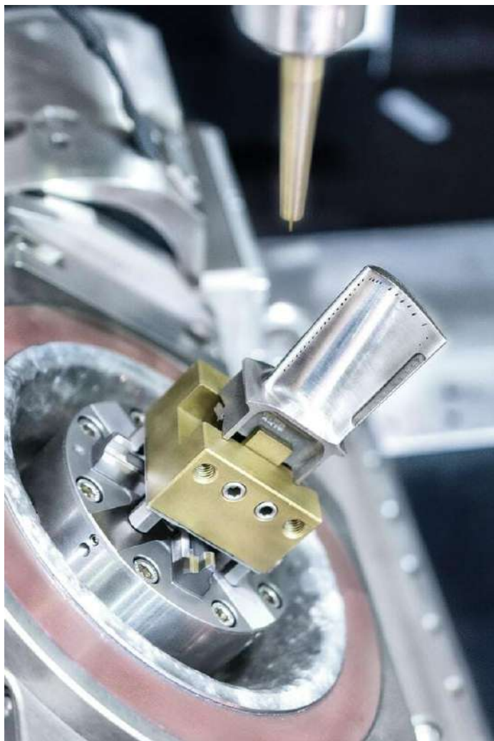
Рисунок 4.7 – Електроерозійна обробка отворів
