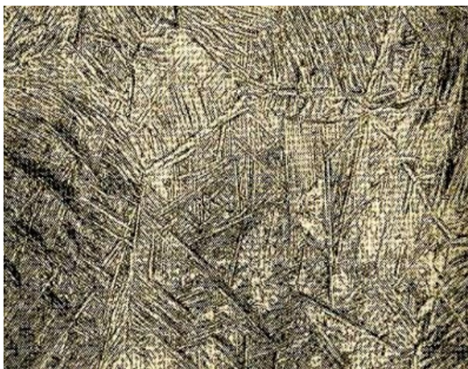
Рисунок 1.7 - Титановий мартенсит \alpha'(\alpha'') , х400
