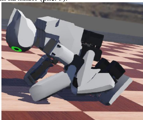
Рисунок 2 – Приклад підйому робота для випадку, якщо він впав на живіт
